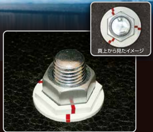
ゆるみ発生 (ラインがずれている)
